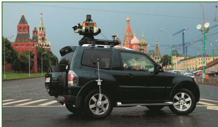
Рис. 1 Система мобильного сканирования IP-S2 Compact+
