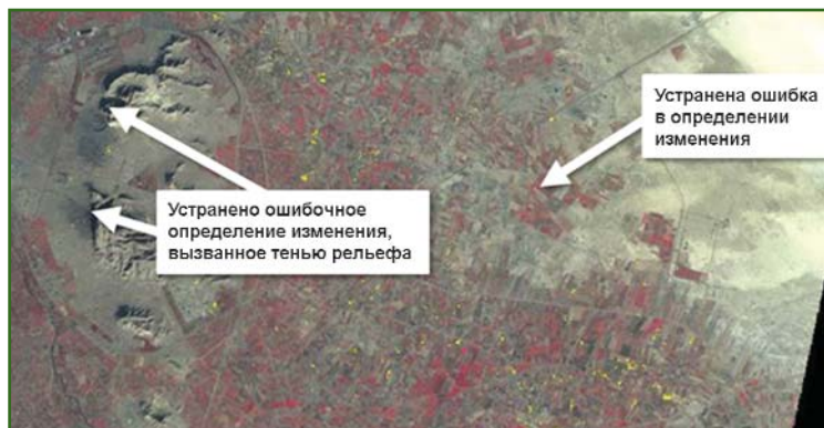
Рис. 4 Изменения, выявленные с помощью сервиса RapidEye PCM (индикаторы изменений обозначены желтым цветом)
