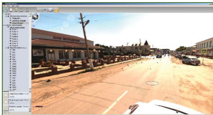
Рис. 6 Виртуальная съемка дороги и придорожной инфраструктуры
